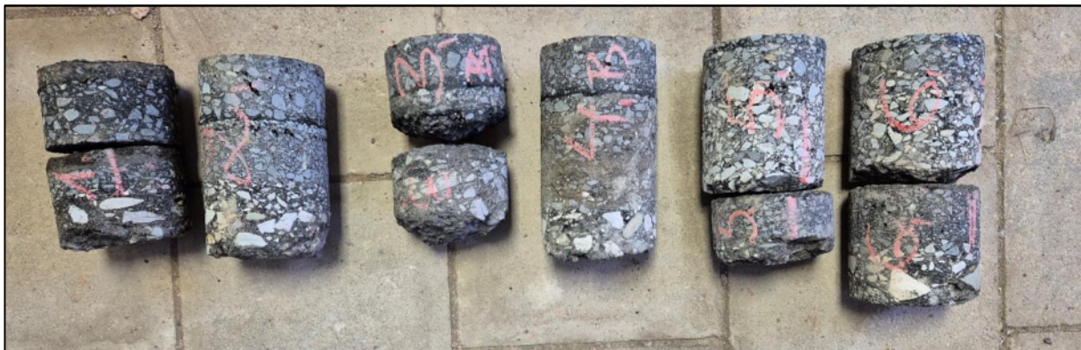
Abbildung 3: Bohrkerne KB 1 bis KB 6 aus der Straßenbefestigung
